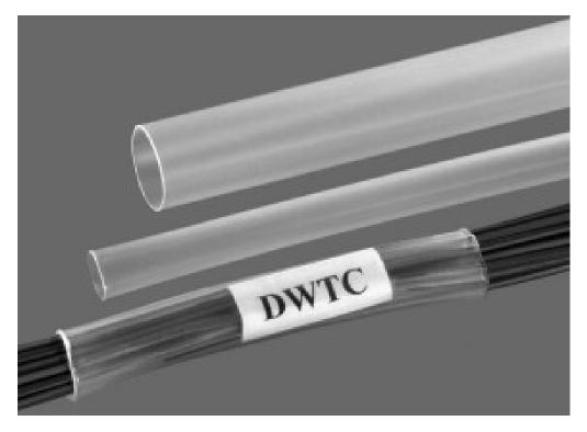
Guaina termorestringente di alta qualità a doppia parete con collante interno. Il **CIERREFLUX CLEAR** non contiene pvc al suo interno, ha una restringimento di 3:1, ed è la soluzione ideale per protezione di giunture sottoposte ad umidità, immersione o sotterrate.
