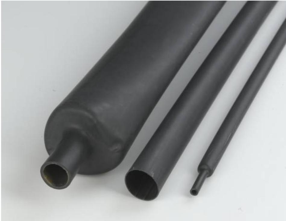
Guaina termorestringente di alta qualità a doppia parete con collante interno. Il **CIERREFLUX** non contiene pvc al suo interno, ha una restringimento di 3:1, ed è la soluzione ideale per protezione di giunture sottoposte ad umidità, immersione o sotterrate. Il **CIERREFLUX** viene fornito in stecche da 1,22 m ed è disponibile in 8 misure di colore nero.
