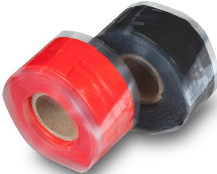
Nastro sigillante agglomerante al silicone. Caratteristiche eccezionali rispetto i normali nastri agglomeranti. Idoneo per alte temperature ( oltre 220°C), isola fino a 15000 V, protegge e sigilla piccole perdite in pressione fino a 7 bar. Approvato anche per acqua potabile.
